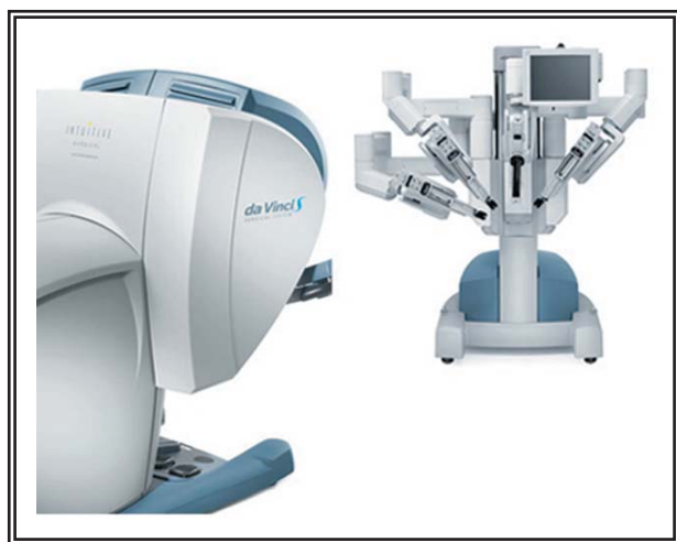
FIGURA 5. Elementos del robot cirujano da Vinci S (consola y soporte con manipuladores).
